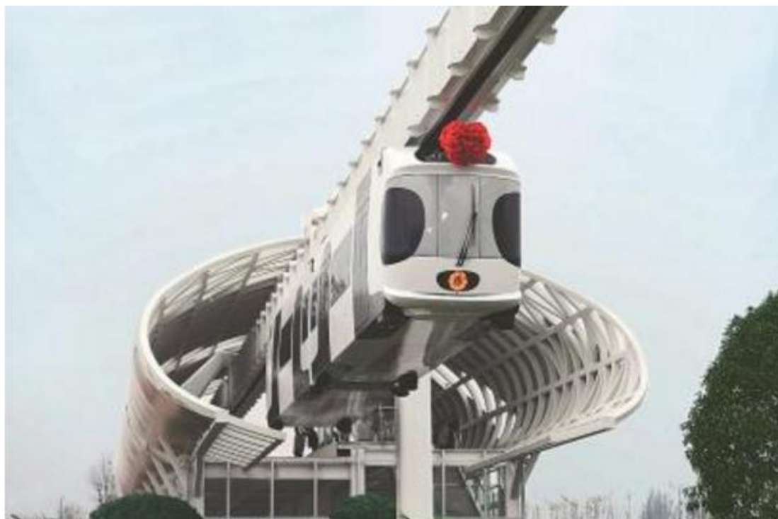
2016年11月21日，全球首条新能源空铁试验线在成都市双流区成功运行，外表为大熊猫样式的列车，整体悬挂在一根箱形轨道梁上，夺人眼球
