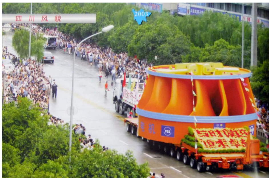
东方电机公司为三峡电站生产的单台装机容量为 75 万千瓦的发电机转轮，重达 440 吨，是当时世界上单机容量和重量最大的水轮发电机转轮。图为 2003 年 8 月 8 日，转轮从德阳起运至三峡。
